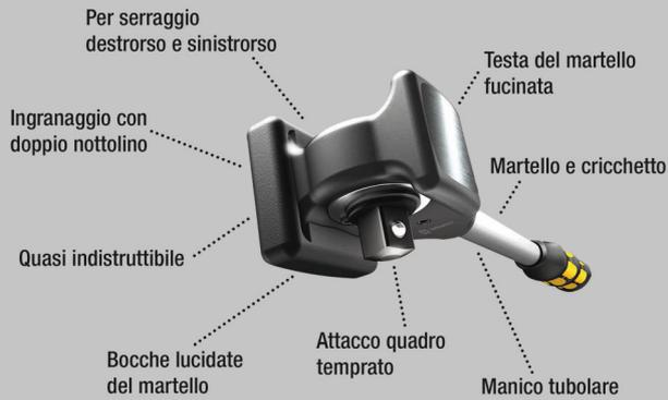
Il cricchetto con funzione di martello. Il Koloss può essere usato come cricchetto reversibile e come cricchetto. Resiste a coppie di almeno 600 Nm. L'ingranaggio con doppio nottolino e l'angolo di richiamo minimo di soli 6° permettono di avvitare in maniera veloce e precisa anche in spazi ristretti.
