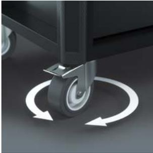
회전 캐스터 2개에 이중 스톱이 장착되어 있음: 잠긴 캐스터는 안정적으로 굴러 다니지 않도록 방지하고 잠긴 스펀들 캐리어는 캐스터가 의도치 않게 돌아가지 않도록 방지합니다(예: 기울어진 표면에서). 탄성이 있는 내구성, 내산성 휠이 원활한 가동을 보장합니다. 보호 링은 먼지와 스레드가 들어가지 않게 방지합니다.
